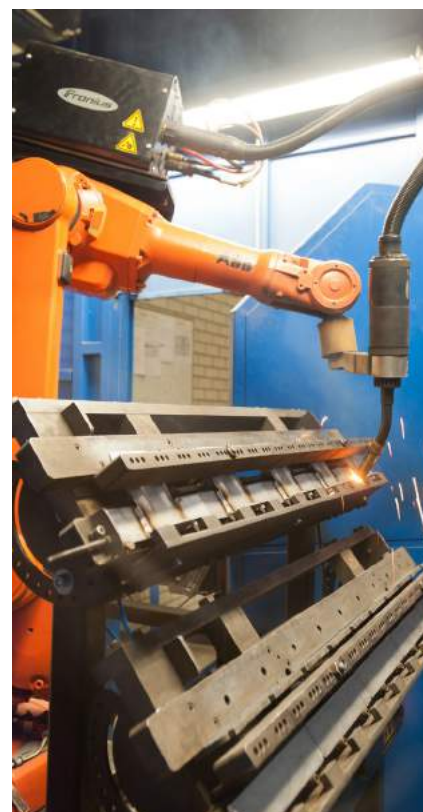
In alto: stabilimento Rewag di AVK Nederland BV dove viene prodotto REPICO® A destra: saldatura robotizzata nello stabilimento Rewag
