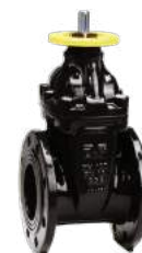
Serie 15/78 Saracinesca flangiata con flangia superiore ISO Corta DIN F4 DN50-400 PN10/16 Ghisa sferoidale Con rivestimento esterno in PUR
