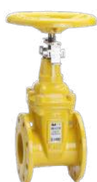
Serie 06/59 Saracinesca flangiata con indicatore di posizione Corta DIN F4 DN50-400 PN10/16 Ghisa sferoidale Con rivestimento epossidico esterno
