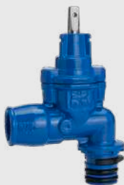
Serie 103/31 - Valvola di derivazione con raccordo maschio Supa Lock™ e raccordo rapido per tubi in PE Ø32-40 mm, ghisa sferoidale.
