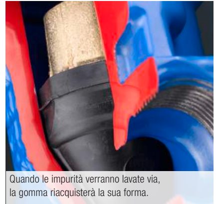
Le impurità vengono assorbite nella gomma quando il cuneo è in posizione di chiusura.
