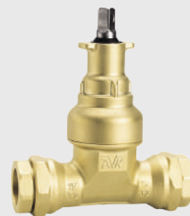
Serie 16/00 - Raccordi a vite resistenti alla trazione per tubi in PE e attacco a T per aste norvegesi.
