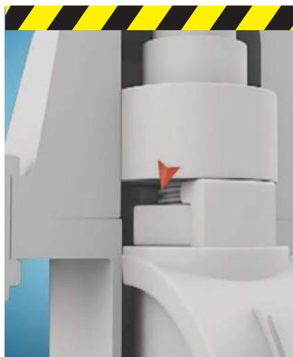
La maggior parte delle valvole a saracinesca sono progettate con una madrevite mobile inserita in una presa a baionetta nel cuneo, dove è difficile ottenere una vulcanizzazione sufficiente della gomma. Il flusso crea vibrazione che allentano il cuneo e di conseguenza porta all'abrasione del sottile strato di gomma.
