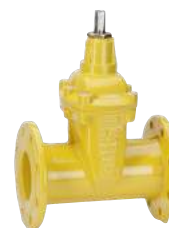
Serie 02/70 Saracinesca flangiata Scartamento DIN F5 DN40-500 PN10/16 Ghisa sferoidale Rivestimento epossidico esterno
