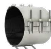
Serie 748/03 Collare di riparazione Fascia tripla Acciaio inox AISI 304 o AISI 316 Gomma in NBR o EPDM
