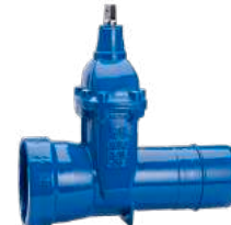
Serie 33/50 Saracinesca con estremità a bicchiere BLS®/ad innesto BLS® per tubi in ghisa DN80-300 PN16 Ghisa sferoidale
