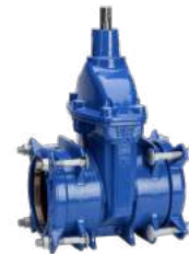
Serie 01/70 Saracinesca con estremità a giunto antisfilamento Supa Plus™ per tubi in PE e uPVC DN40-300 PN16 Ghisa sferoidale
