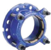
Serie 623/10 Giunto adattatore flangiato Supa Plus™ Antisfilamento per tubi in PE e uPVC DN40-300 PN10/16 Ghisa sferoidale
