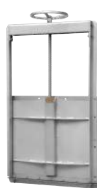
Serie 772/61 Paratoie a muro Bidirezionale fino a 1200x1200 mm incluso, bidirezionale o unidirezionale nelle dimensioni maggiori Con albero non saliente Acciaio inox AISI 304 200 x 200 mm - 2000 x 2000 mm
