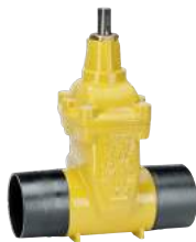
Serie 46/64 Saracinesca con estremità a saldare corto DN50-300 PN16 Acciaio fuso GP240GH Rivestimento epossidico esterno
