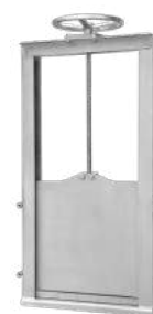
Serie 772/7172 Paratoia per canale Unidirezionale fino a 1000x1000 mm incluso, bidirezionale nelle dimensioni maggiori Con albero non saliente Acciaio inox AISI 304 200 x 200 mm - 2000 x 2000 mm
