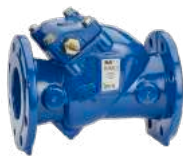
Serie 41/60 Valvola di ritegno Albero libero Tenuta gommata DN50-300 PN10/16 Ghisa sferoidale
