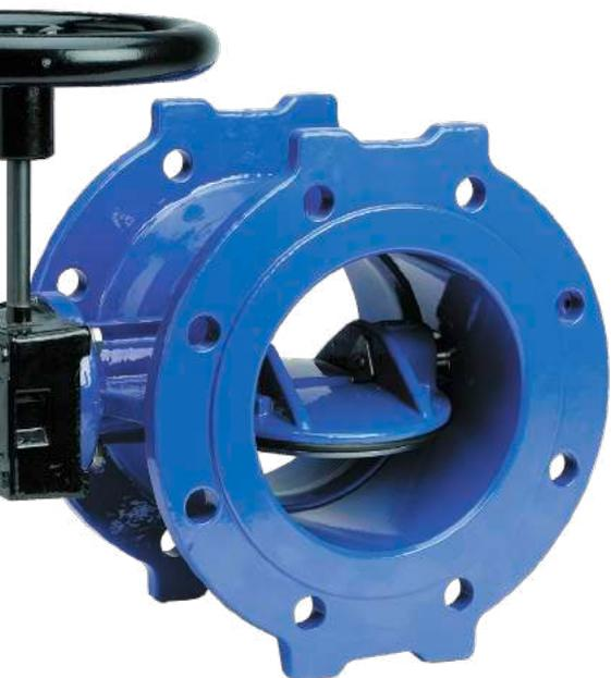
AVK offre valvole a farfalla a doppio eccentrico nei DN150-2800 progettate per garantire una maggiore durata. Il disco decentrato e montato saldamente, il design ottimizzato della tenuta e i semialberi protetti dalla corrosione, sono caratteristiche che superano gli standard del mercato.
